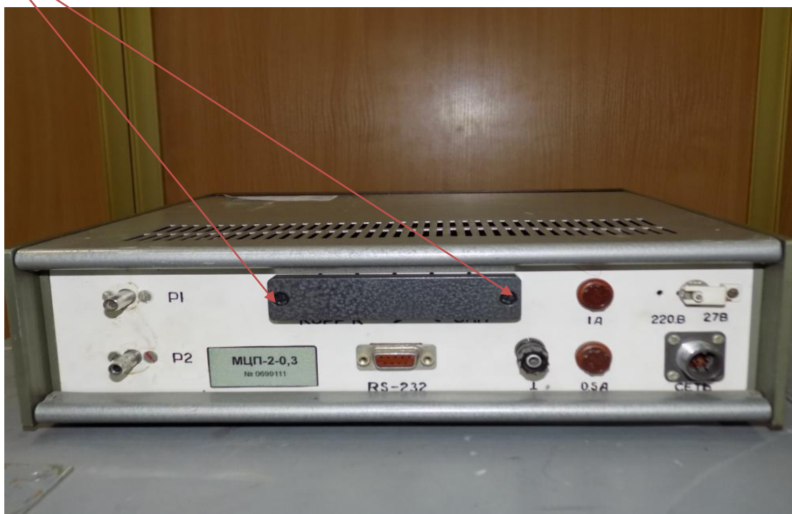
Рисунок 2 - Схема пломбировки манометра цифрового прецизионного МЦП-2-0,3 от несанкционированного доступа
